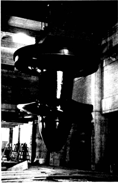
Turbine complète prête à la mise en place dans le cuvelage.
