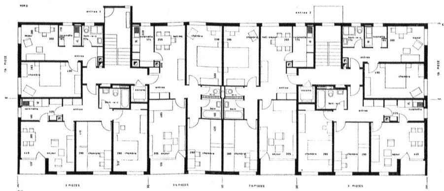
Immeuble B. Plan des étages, échelle 1 : 300
