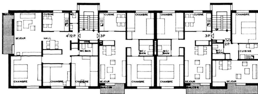
Plan d'un étage courant. Echelle 1 : 300
