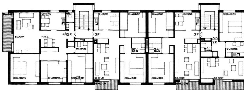
Plan d'un étage courant. Echelle 1 : 300
