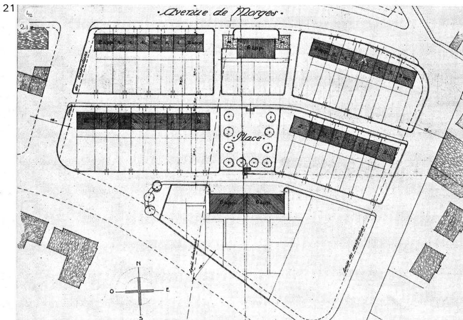
19. 20. Logements ouvriers construits par la Maison ouvrière, situés à la Borde. Architecte: Regamey. Les immeubles sont implantés en bandes parallèles et orientés est-ouest (plan des étages + façades).
