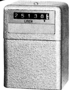
Compteurs à mazout HZ 4 montage dans les brûleurs de toutes marques entre la pompe à huile et l'injecteur plage de mesure de 1 à 50 l/h exactitude \pm 1\%
