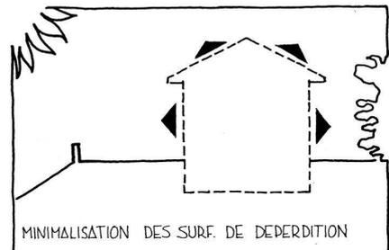
L'énergie solaire étant transmise à l'intérieur du bâtiment par la façade sud, il convient de prévoir une disposition des locaux permettant la circulation et le transport de cette énergie calorifique vers les espaces situés dans les parties nord de la maison.
