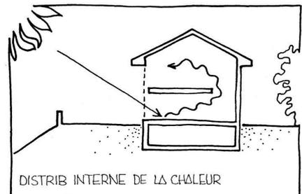
C'est pour cette même raison que l'on cherchera à disposer des espaces-tampons au nord (p. ex. garage, réduit, etc.) pour se couper des «murs froids» et sous la toiture pour se préserver de la surchauffe estivale. L'indispensable «sas d'entrée» entre dans cette catégorie d'espaces-tampons.
