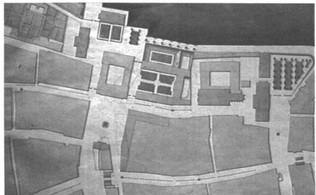
Ahasver Carl von Sinner: Zeughausprojekt 1788. Grundriss der Gesamtanlage. Dunkler eingezeichnet sind die geplanten Neubauten.
