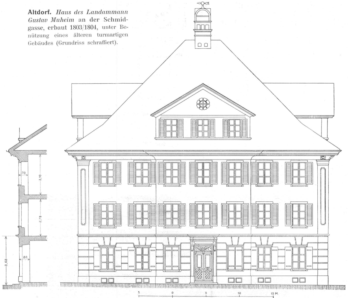
Geometrische Ansicht der Ostfassade mit Schnitt. Masstab 1:150.
