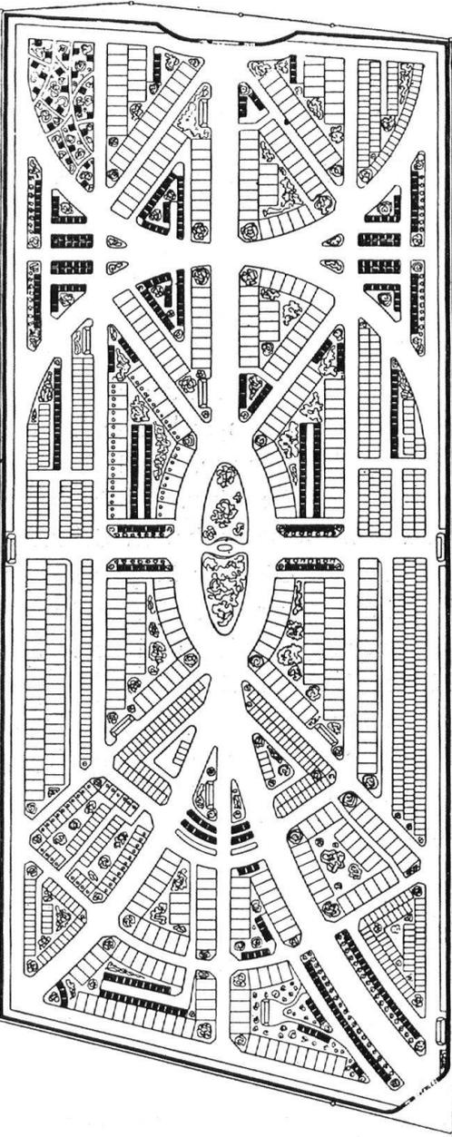
Abb. 5. Ursprünglicher Entwurf zu einem Friedhof. Wegenanlage und Bepflanzung erscheinen zwar nicht systemlos, befriedigen aber trotzdem nicht, weil das System nur auf dem Plan wirkt, in der Ausführung aber unübersichtlich wird. — Fig. 5. Plan original de cimetièrre. Le tracé de chemins et les plantations ont bien quelque chose de systématique, mais ne satisfont pourtant pas, parce que les système, visible sur le papier, ne l'est plus dans la réalisation.
