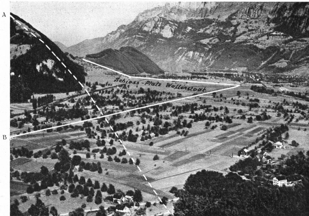
Abb. 8. Leitungsführungen bei Wallenstadt. Die Punktlinie zeigt die projektierte Höchstspannungsleitung. Diese kann auf das, wegen Kabelverlegung frei gewordene, Telephontracé (weisse Linie) verlegt werden. In der Mitte des Hintergrundes ist die weithin sichtbare Schneise über die Reischibe erkennbar. — Fig. 8. Conduites électriques près de Wallenstadt. La ligne pointillée marque la ligne projetée à haute tension. Elle pourra prendre la place de la ligne téléphonique (ligne blanche), actuellement en câble souterrain. On remarque à l'arrière-plan la coupure, qui a été faite pour une conduite électrique à travers la forêt de la Reischibe.
