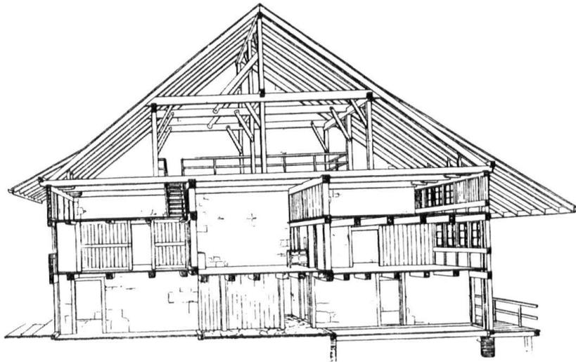
Schnitt durch das Haus rechts. Ganz rechts die erhöhte Laube unter weiter vorspringendem Dach. Dahinter die Werkstatt, links ein Stall. In der Mitte die Rauchküche mit den Wohnstuben und darüber die Schlafgaden. — Coupe de la maison à droite avec les «arcades» à droite sous le toit saillant. Au milieu la cuisine sans issue pour la fumée, pour fumer le lard et les jambons; des deux côtés des chambres et, au-dessus, les dortoirs.
