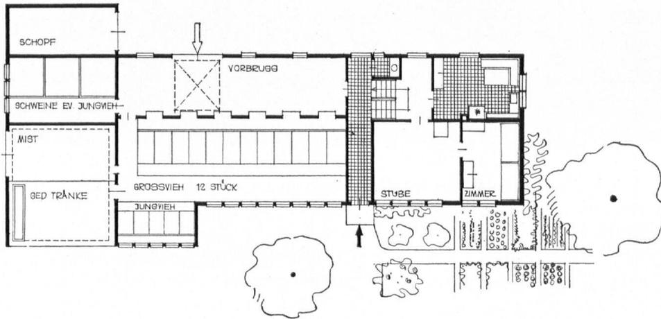
*Weiter entwickelte Form des alten sog. Heidenhauses (mit Längsstall). Eine zwar bescheidener wirkende, aber in den Kosten und im Gebrauch sehr empfehlenswerte Bauform.*
