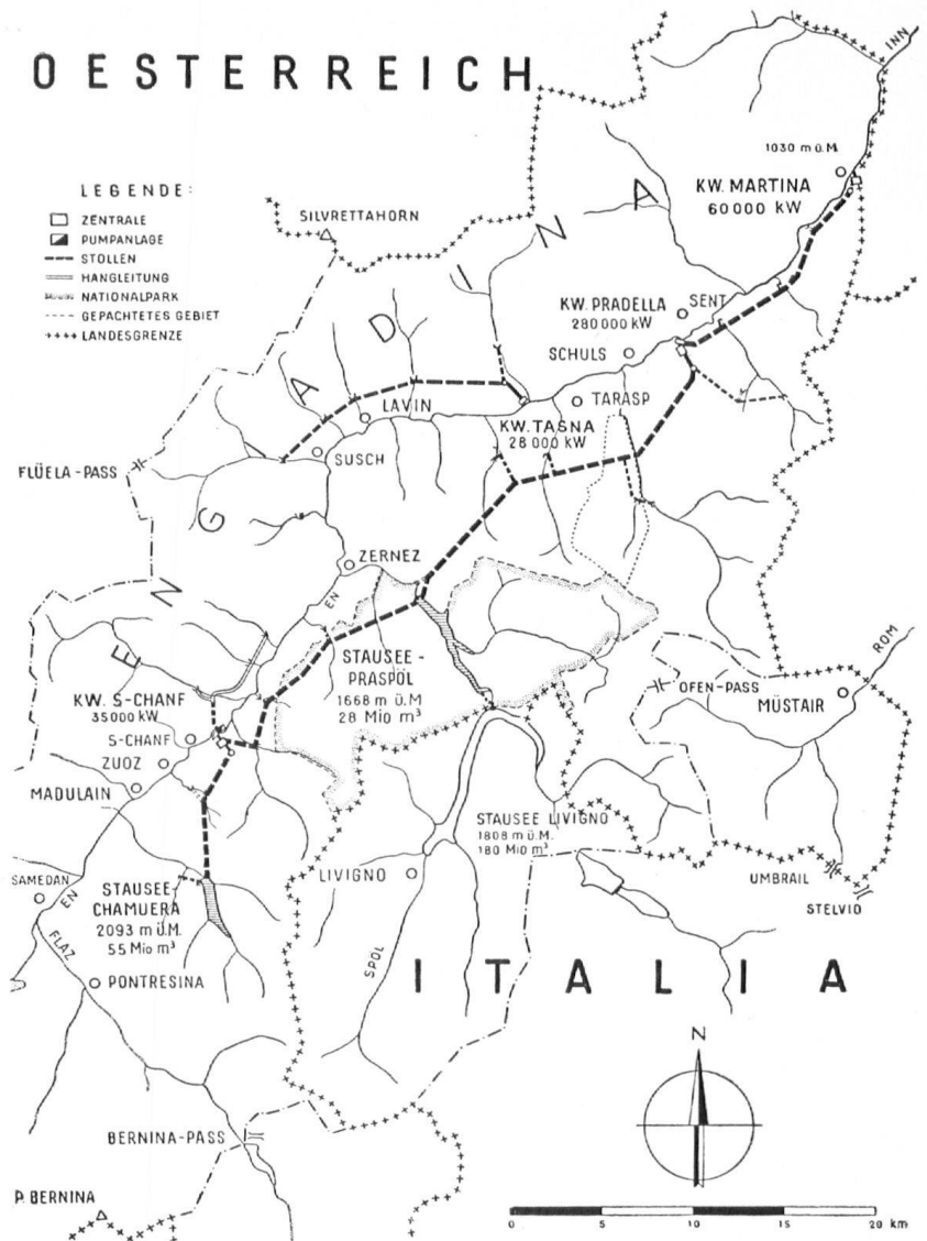
Exploitation des forces hydrauliques sur le plan cantonal: projet 1955 des Entreprises engadinoises comportant, dans le Parc National, le lac de Praspöl (28 millions de m 3 , conçu par l'ingénieur de Salis en 1919).
