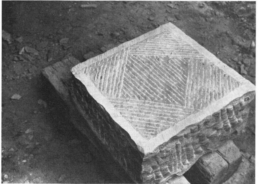
Die so vorbereitete Sichtfläche wird mit dem ‚Zweispitz‘ oder der ‚Fläche‘ – zwei Formen der Steinaxt – fertig bearbeitet. Bei dieser Bearbeitung bleibt ein mehr oder weniger breiter ‚Saum‘ (Schlagrand) stehen. Die ‚Fläche‘ verleiht dem Werkstück eine eigenartig belebte, in der Gesamtwirkung jedoch ruhige Oberfläche.
