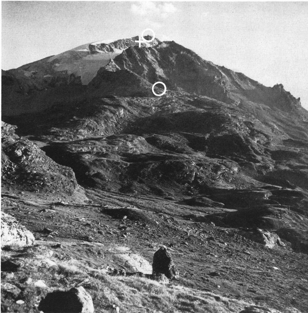
Der untere Kreis deutet die Mittelstation an, der obere die Endstation auf dem Murtelgrat. Das Kreuz auf dem Vordergrat zeigt die Stelle, wo der einzige Tragmast des oberen Bahnabschnittes hinkäme. Links, außerhalb des Bildrandes, die Fuorcla Surlej.
