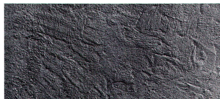
La chaux en pâte peut être modelée, talochée, lissée ou structurée aisément (photo Baertschi).
