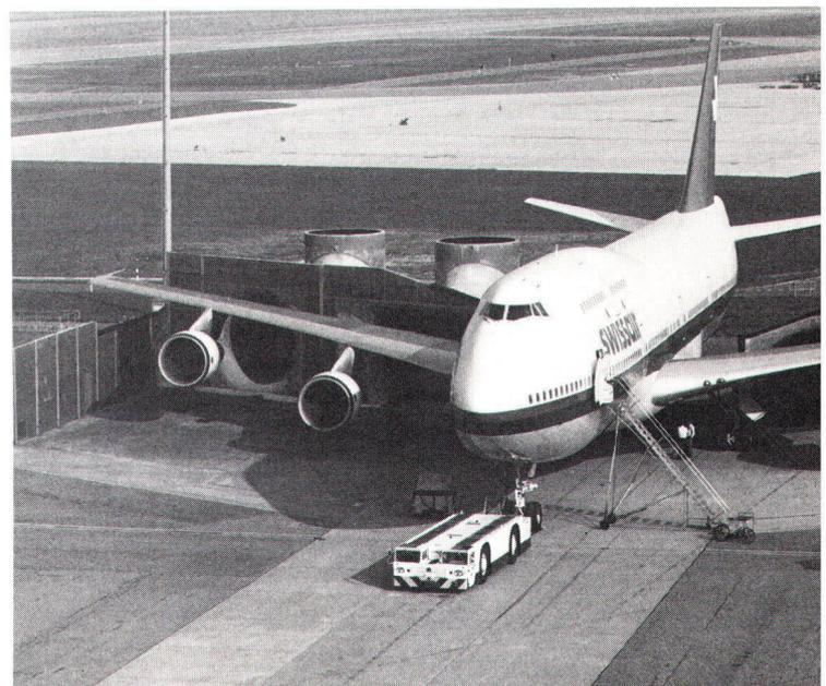
*Jumbo-Jet faisant tourner ses réacteurs auprès d'un amortisseur de son de la Swissair; leur bruit, avec cet appareil, est à 2,5 km de distance inférieur à celui d'une camionnette.*
