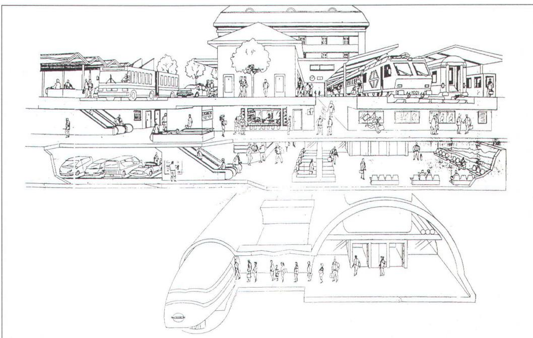
*Das Röhrensystem der Swissmetro würde an das bestehende öffentliche Verkehrsnetz angeschlossen (Skizze Swissmetro).*
