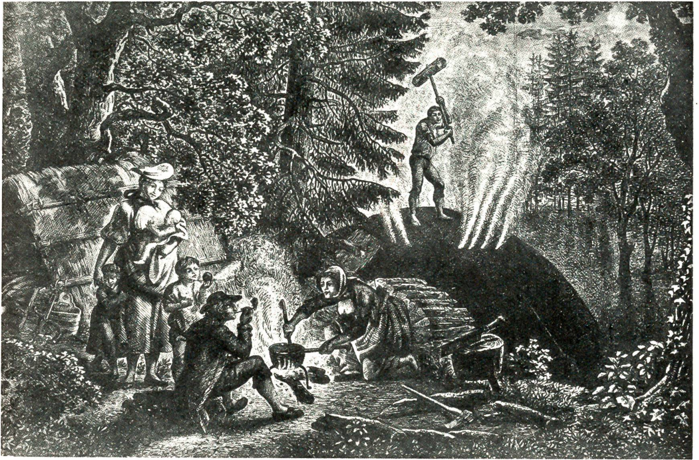
Kohlenmeiler, wie sie früher um Eggwil häufig vorkamen. Die viel verwendete Holzfohle wurde durch Verbrennen von Holzhausen hergestellt, die mit Erde überschüttet waren, damit das Holz bei möglichst geringem Luftzutritt langsam verkohlen konnte. Kupferstich aus dem Jahre 1819 von Gabriel Lorn
