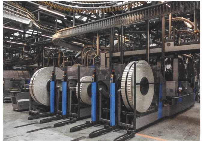
Zeitungsproduktion heute: Von der Rotationsmaschine leiten komplexe Fördersysteme die gedruckten Zeitungen wie von Geisterhand geführt zur automatischen Adressierung. Ganz ohne menschliches Zutun läuft aber auch dieser Prozess nicht ab.
