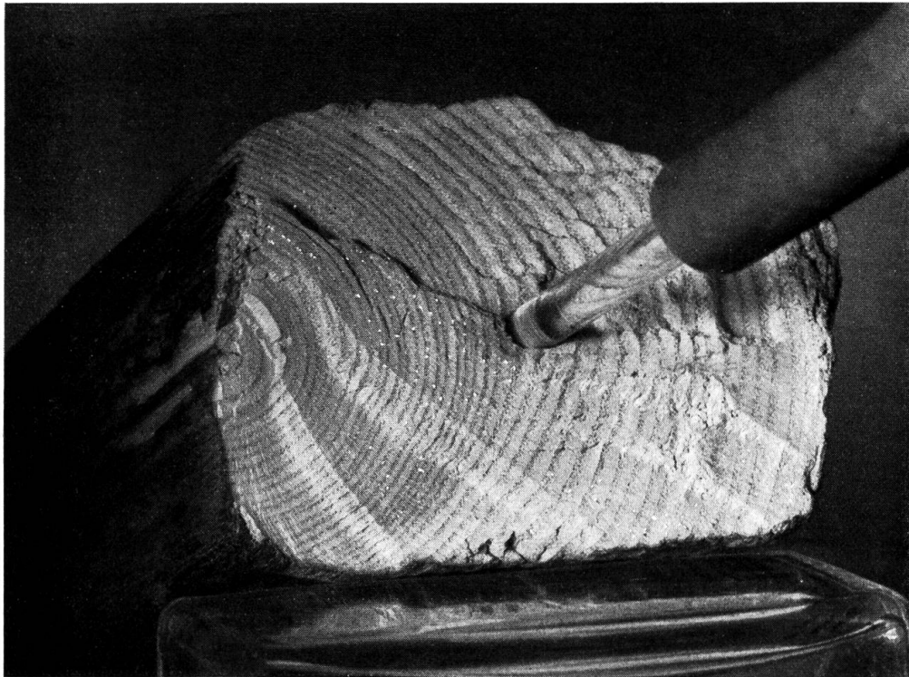
Abb. 1. Feuchtholz durch Einsetzen einer Glassonde zur Innenträngung vorbereitet
