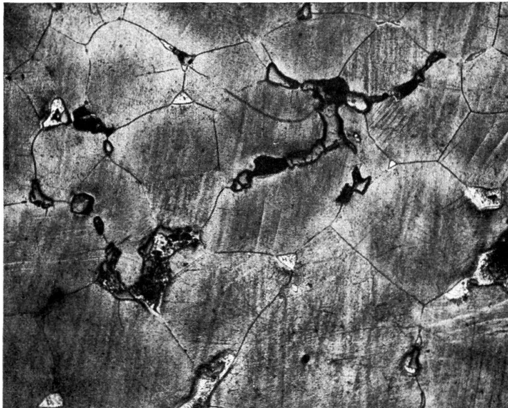
Abb. 20. Fragment III. Geätztes Schliffbild (Ätzung: \text{FeCl}_3 \cdot \text{HCl} , Vergrößerung: 100)
