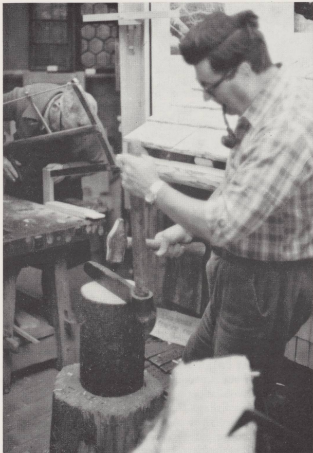
Fabrication de tavillons ou « échandelles » par Noël Chappuis, de Develier.
