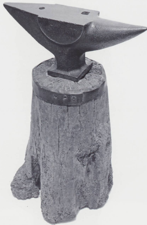
Figure 20 Enclume de ferblantier. Hauteur 17,5 cm, largeur 44 cm, épaisseur 10 cm; poids total avec socle: 35 kg, sans le socle 23 kg ; 1 œillet porte-outil, 1 œillet à percer. (Photo JLM.)
