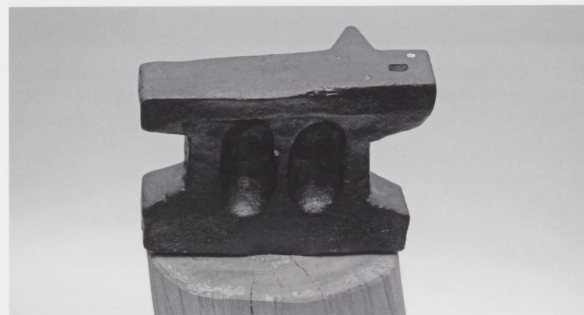
Figure 8 Enclume de ferblantier dite « à corps ». Hauteur 17 cm, longueur 25 cm, largeur 7 cm, poids 31 kg avec socle ; carrée aux 2 bouts ; nez sur le côté ; côté opposé 2 voûtes ; 1 œillet porte-outil. (Photo JLM.)
