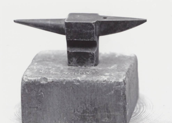
Figure 22 Enclume d'horloger (?). Hauteur 22 cm (outil 10 cm), longueur 23 cm, largeur env. 4 cm, poids 2 kg ; 1 support sur bois tourné en forme de cloche ; 1 bigorne ronde, 1 carrée, un petit trou à percer. (Photo JLM.)
