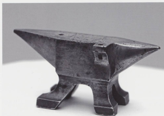
Figure 23 Enclume d'horloger (?). Hauteur 4,5 cm, longueur 10 cm, largeur 2 / 3 cm (avec nez comprenant un œillet porte-outil), poids env. 0,2 kg ; en laiton ; 1 bigorne à pointe carrée, 1 arrondie, 1 œillet à percer. (Photo JLM.)
