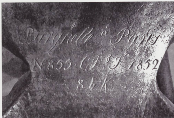
Figure 4 Enclume de forgeron. Hauteur 25, longueur 66, largeur 14, poids 84 kg ; 2 bigornes dont une ronde et une carrée ; un œillet porte-outil. Détail de l'inscription : Burghelle à Paris, N° 855 CP & F, 1852, 84 K (Photo JLM.)
