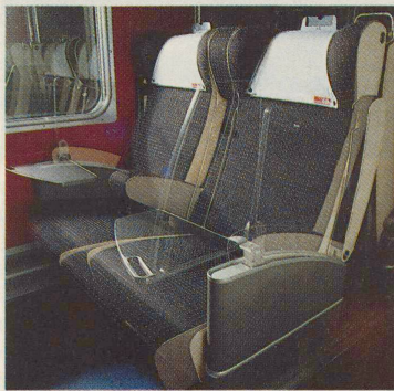
In der Seitenlehne ist der Esstisch eingebaut...
