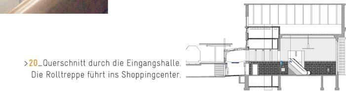
>20\_Querschnitt durch die Eingangshalle. Die Rolltreppe führt ins Shoppingcenter.
