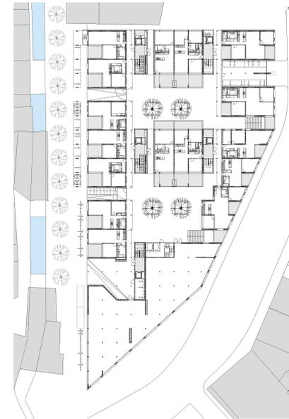
^16\_Grundriss Hochparterre. Der Schüsskanal in der Gerbergasse wird freigelegt.
