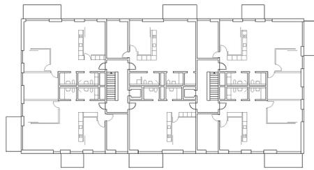
^ Grundriss Regelgeschoss: Erschliessung und Nassräume sind betoniert, andere Raunteilungen im Leichtbau.
