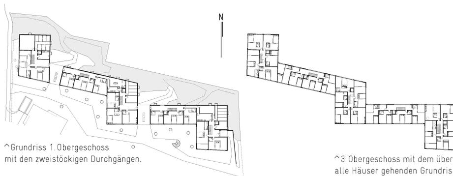
^Grundriss 1. Obergeschoss mit den zweistöckigen Durchgängen.
