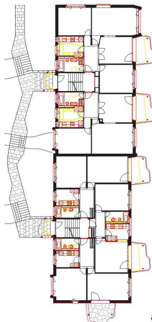
Grundriss gelb Abbruch, rot Neubau.
