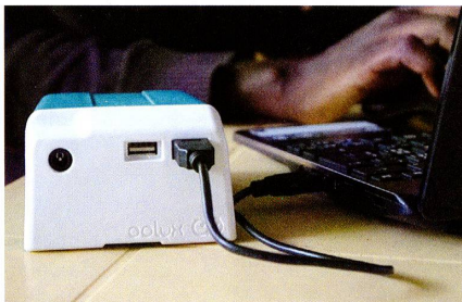
Mittels einer Software werden die bezahlten Stunden Strom freigeschaltet.
