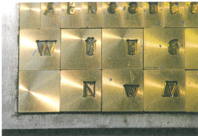
Sieben der breitesten von über hundert Messingmatrizen der «Parnassia».
