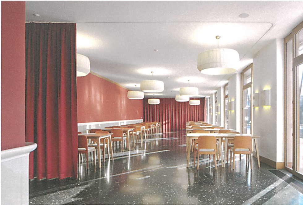
Der Abschluss des Täfers ist gleichzeitig Handlauf. Der Speisesaal kann mit Vorhängen vom übrigen Hofumgang getrennt werden.
