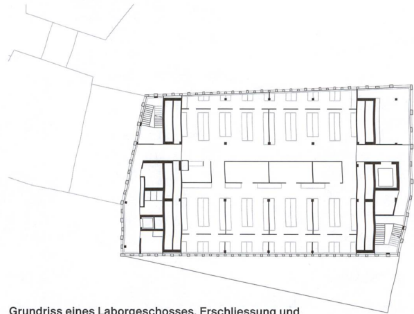
Grundriss eines Laborgeschoßes. Erschliessung und Nebenräume liegen aussen. | Plan d'un étage de laboratoires. Les espaces communs de service se trouvent aux extrémités.
