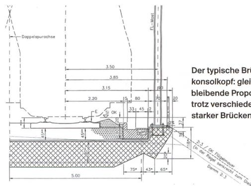
Der typische Brückenkonsolkopf: gleichbleibende Proportionen trotz verschieden starker Brückenplatten.
