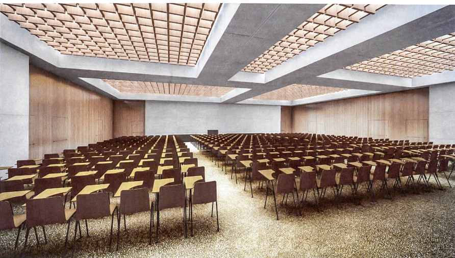
Betonträger gliedern die Decke des Hörsaals. Sie sind zugleich Halterung für die Trennwände.
