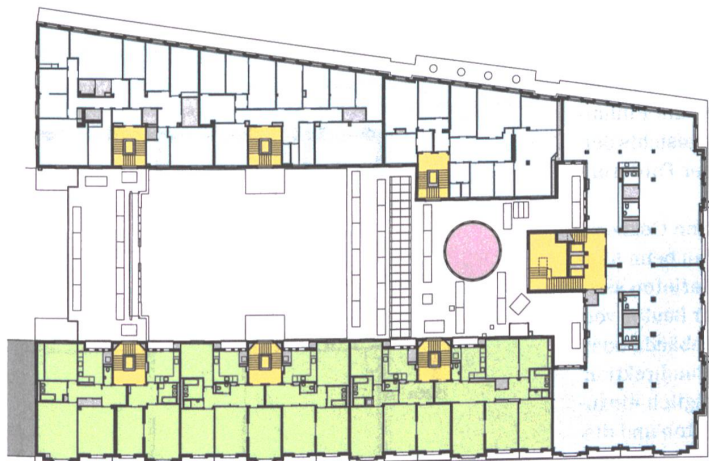
1. Obergeschoss. Die Büros waren ursprünglich Wohnungen.
