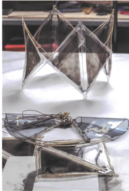
Module mit elektroaktiven Polymeren, kombiniert mit akustischen Membranen.
