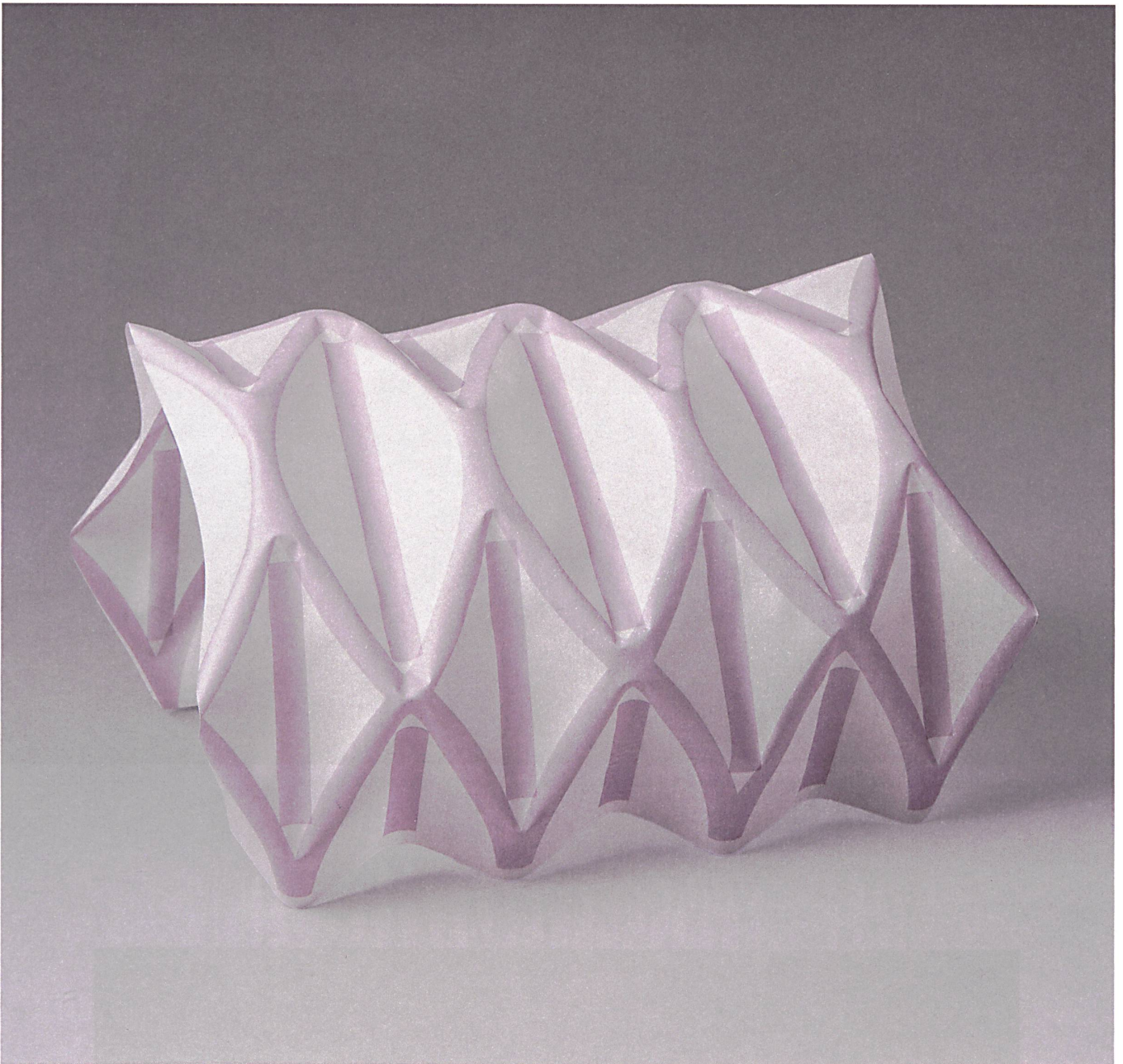
Mit «Hydro-Fold» schloss der Designer Christophe Guberan 2012 seinen Bachelor in Lausanne ab. Ausgedruckt faltet sich das Transparentpapier zu einem Körper. Das chemisch behandelte Papier belässt die Feuchtigkeit auf der Oberfläche.
