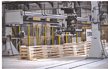
20 Ein Roboter montierte die 48 624 Latten zu Trägern zusammen.
