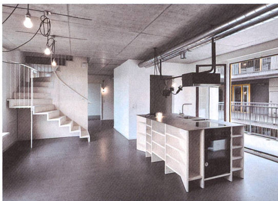
Küchenblock und Treppe sind aus Holzplatten gebaut.
