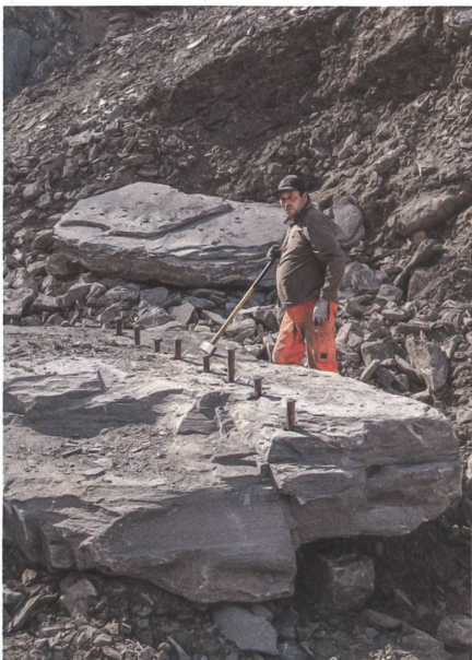
Die 25 Zentimeter dicken Steinplatten wurden im Tal hergestellt.
