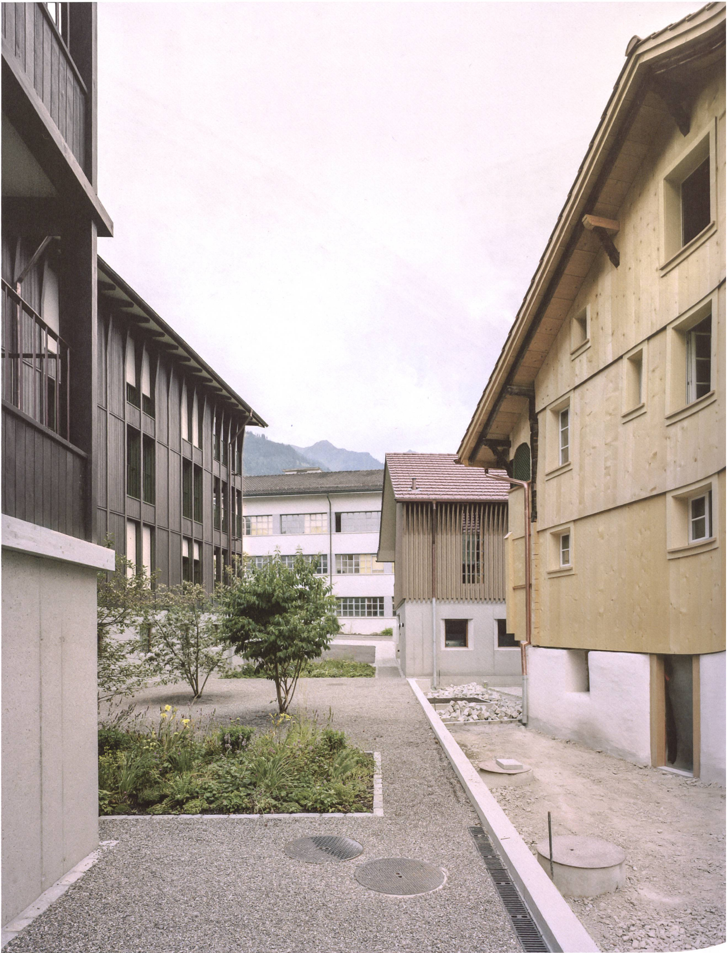
Feine Niveausprünge und Materialwechsel von Kies über Asphalt bis Pflasterstein stufen den Grad an Privatheit ab.
