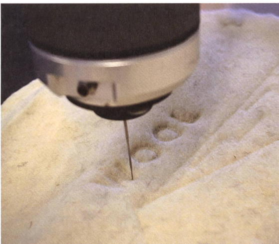
Automatisierter Filzprozess, umgesetzt von einem Roboterarm.
