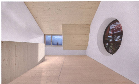
Untergeschoss und Geschossdecken sind aus T3S-Brettsperrholz gebaut.
