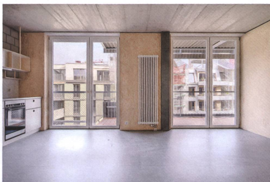
Einfach materialisiert: Beton, Kalksandstein, Sperrholz und Linoleum.
