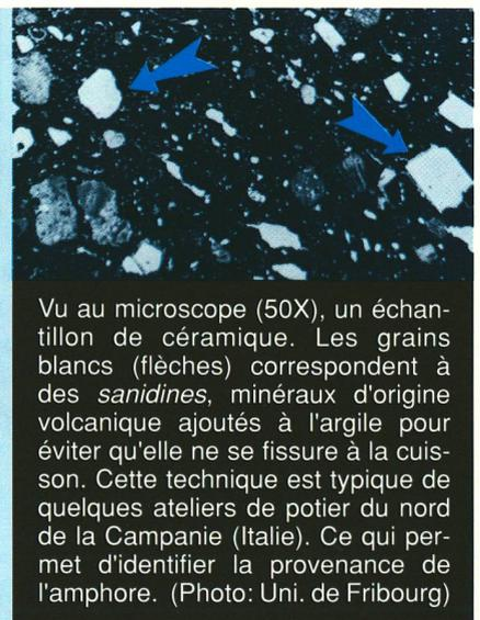
Vu au microscope (50X), un échantillon de céramique. Les grains blancs (flèches) correspondent à des *sanidines*, minéraux d'origine volcanique ajoutés à l'argile pour éviter qu'elle ne se fissure à la cuisson. Cette technique est typique de quelques ateliers de potier du nord de la Campanie (Italie). Ce qui permet d'identifier la provenance de l'amphore. (Photo: Uni. de Fribourg)
