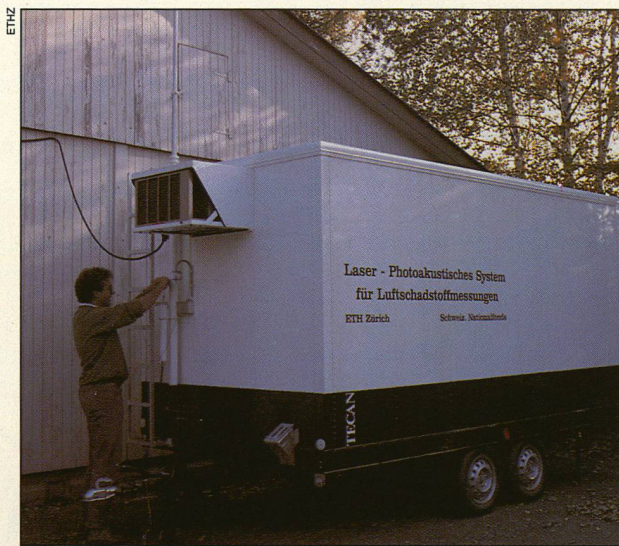
Installé dans une caravane, le détecteur «Laser-PAS» est facilement transportable aux quatre coins du pays.
