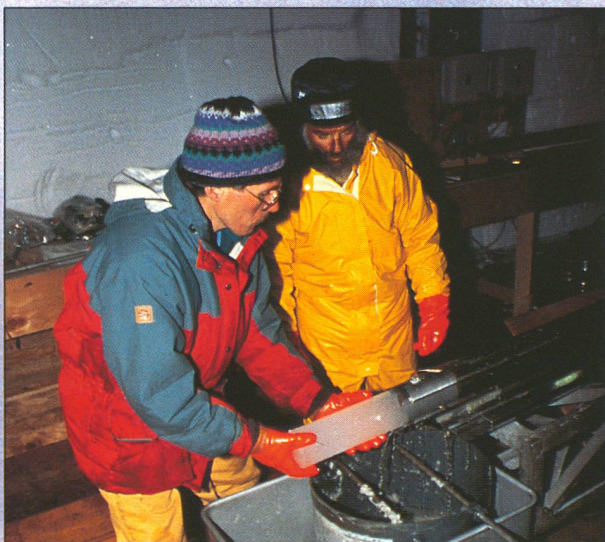
Les physiciens ont prélevé une carotte de glace polaire pour déterminer le CO 2 atmosphérique du passé.
