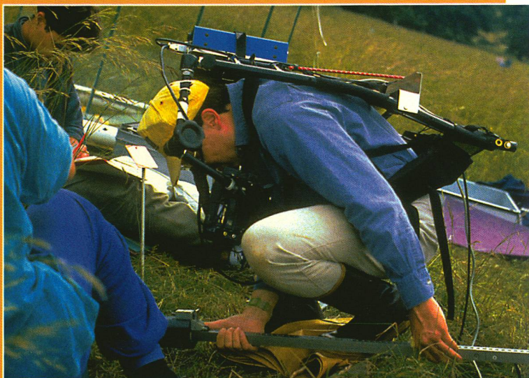
Ce chercheur observe des racines au moyen d'une caméra souterraine.
