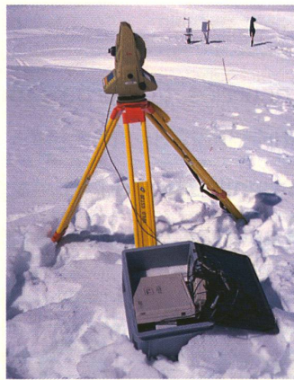
Le théodolite à laser mesure la position du géoradar.
