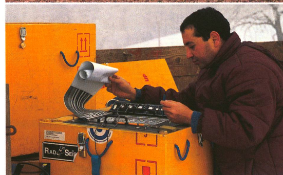
Dans la région lucernoise, les chercheurs bernois procèdent à des sondages (en haut) et recherchent avec un géoradar les couches recelant des objets.
